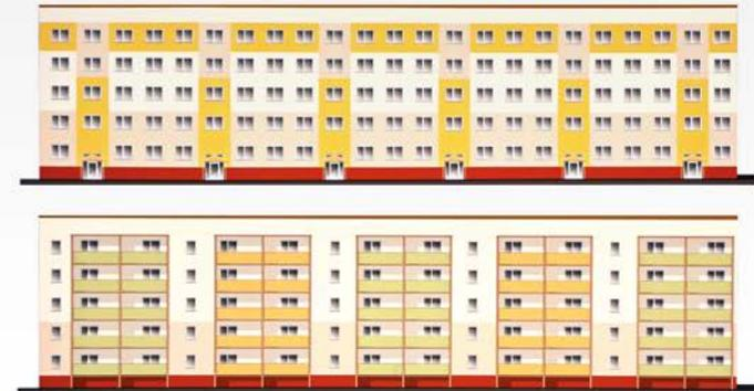
Eine grundhafte **Sanierung** der bauzeitlichen **Balkone der K.-Liebknecht-Str. 19–23 und 25–29** macht sich erforderlich. Neben der **Erneuerung der Balkonbodenplatte** wird die massive Brüstung durch ein **Balkongeländer in Stahl-Leichtbauweise mit Trespa-Ausfachung** ersetzt.
